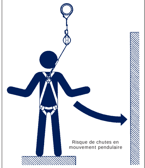
Figure 3 - Chutes en mouvement pendulaire
